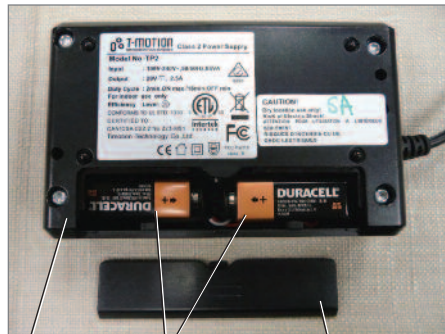
Transformador de corriente Baterías alcalinas de 9 voltios Cubierta de las baterías
